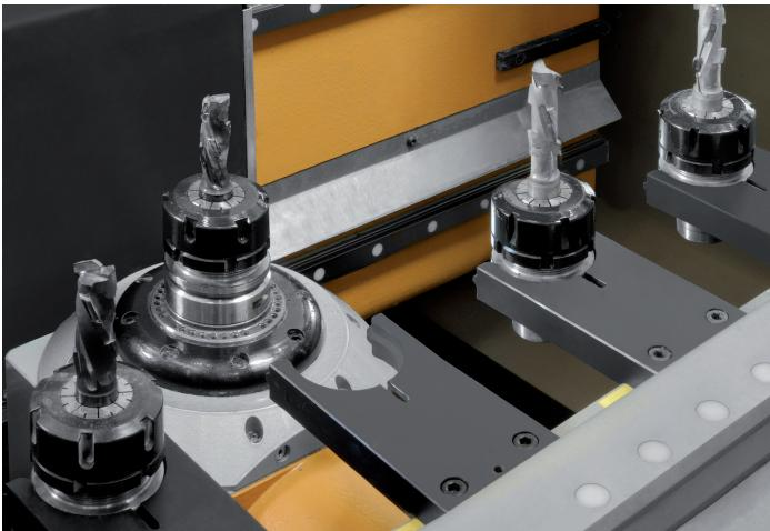
**CENTRO DE TRABAJO A CONTROL NUMÉRICO PATENTADO PARA EJECUTAR LOS TRABAJOS EN LOS PANELES TOPS O MÉNSULAS, DOTADO DE DOS CABEZALES A FRESTAR CONTRAPUESTAS (UNA SUPERIOR Y UNA INFERIOR), QUE TRABAJAN SIMULTÁNEAMENTE SOBRE TODA LA SUPERFICIE DEL INNOVATIVO PLANO DE TRABAJO.**
